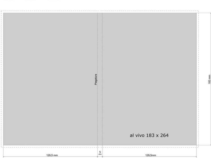
Prevedere 3 mm di margine di abbondanza sulle reali misure del progetto.
